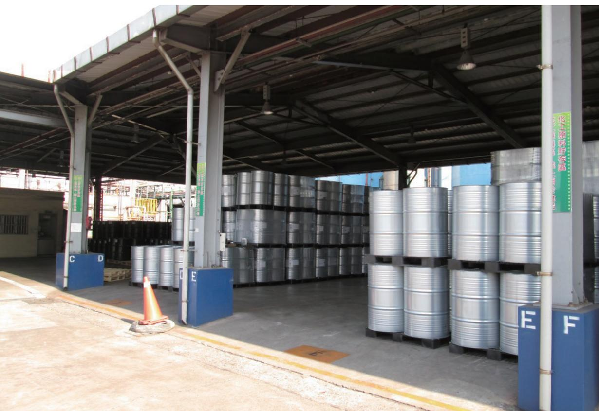
廠區遵循公司生產安全的政策，原料分類存放，並設置防液堤及製程溝，提供洩漏時之安全防護，避免對周遭環境造成危害。所有作業場所皆依照 SOP 操作，遵守作業安全衛生守則，設備確實接
